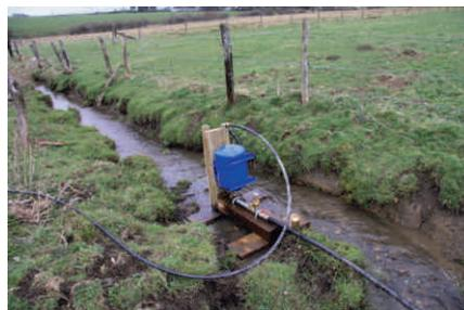
Il s'agit d'une part du **bélier hydraulique** et d'autre part de la pompe rotative. Le premier permet de mettre à profit une faible dénivellée pour faire gravir à l'eau une hauteur jusqu'à 30 fois supérieure. La différence de niveau minimale est de 1 à 2 mètres, soit une pente de la source comparable à celle nécessaire au fonctionnement de l'abreuvoir gravitaire. Ce système convient pour tous les cheptels. Il nécessite toutefois un réglage initial qui peut être délicat
